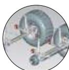
TRASLACIÓN MEDIANTE DOS EJES CON COMPENSACIÓN Y SUSPENSIÓN HIDRÁULICAS
